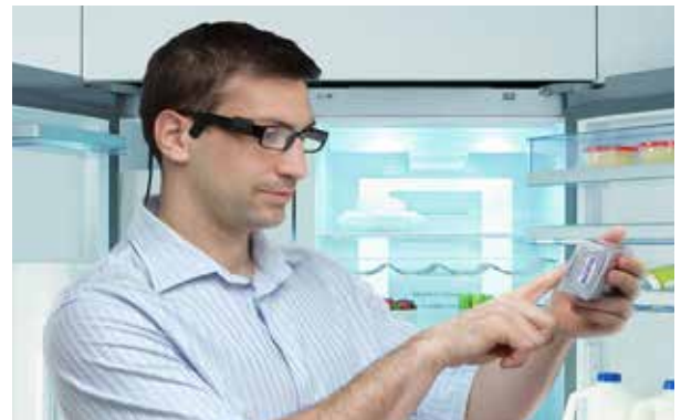
OrCam liest Ihnen mit einer intuitiven Fingergeste den gewünschten Text vor. OrCam MyEye erkennt dank des integrierten Barcode-Lesers das jeweilige Produkt.
