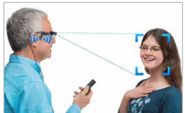
OrCam MyEye erkennt Personen innerhalb von 3 m und teilt den zuvor gespeicherten Namen mit.
