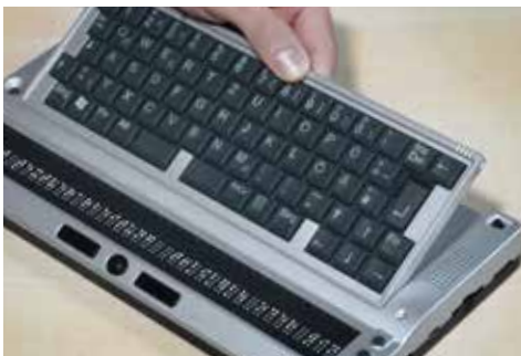
Mit nur wenigen Handgriffen lassen sich Braille- und Standardtastatur während des Betriebs auswechseln.
