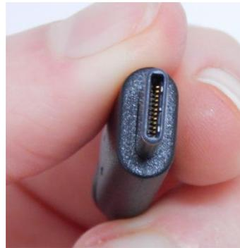
Auf der rechten Geräteseite der Vario 480 befindet sich der USB Anschluss in Form einer USB Typ C Buchse. Das Besondere an dieser Buchse ist die Symmetrie des Steckers. Es ist egal, wie herum Sie den Stecker einstecken, Sie müssen nicht mehr umständlich herausfinden, wo die Ober- und die Unterseite ist.
